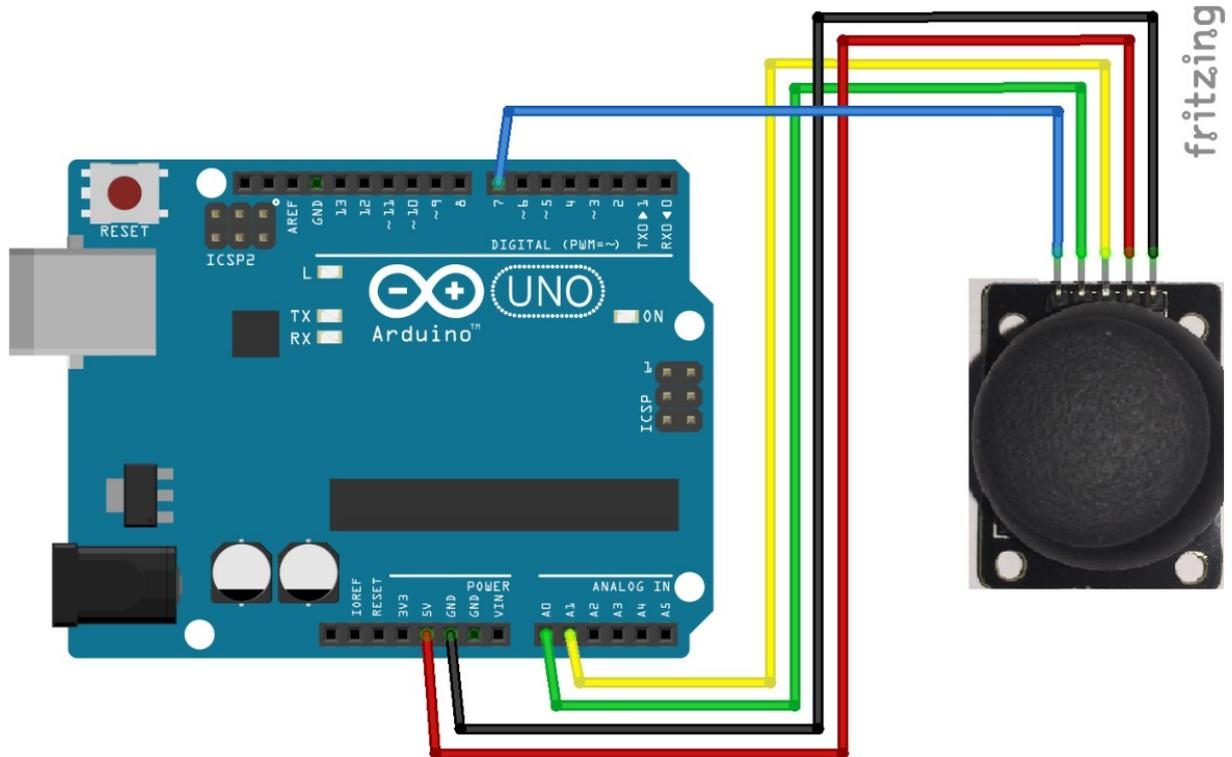
**+5V** wird mit **5V** am Arduino verbunden
