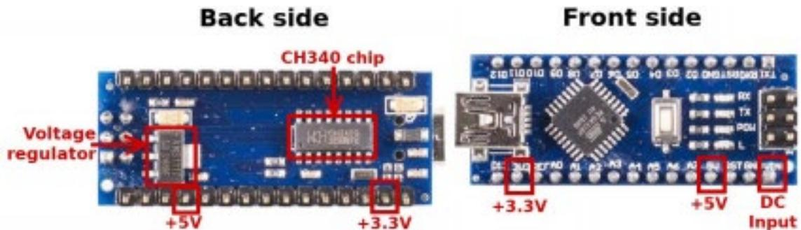
Ein Nano V3 verfügt über einen DC-Spannungsregler für +5V, **VIN**-Pin (DC-Eingang auf dem Bild links). Sie können eine externe Gleichstromversorgung an den **VIN**-Pin auf der Platine mit einer Spannung im Bereich von 7V bis 12V anschließen. Der Spannungsregler senkt und stabilisiert sie auf +5V. Die Ausgangsspannung von +3,3V können wir vom CH340-Chip erhalten. Sie ist NICHT genau und somit NICHT stabil.
