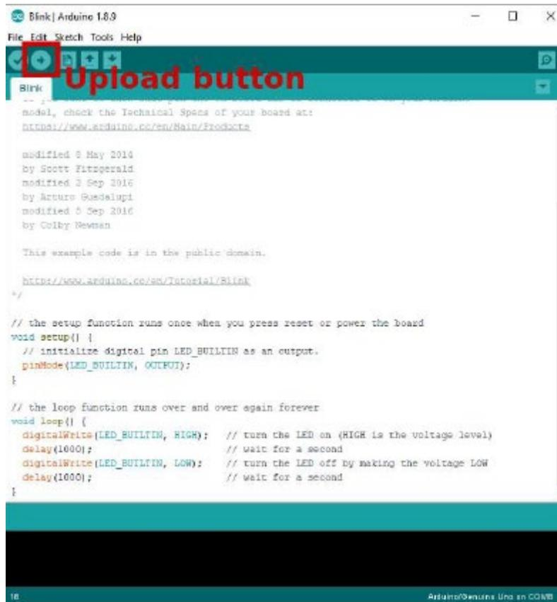
Danach sollte die eingebaute LED anfangen in einem Zeitintervall von einer Sekunde zu blinken
