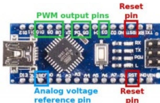
6 von 14 digitalen Ein-/Ausgangspins können als PWM-Ausgänge (Pulsweitenmodulation) verwendet werden. Diese Pins sind D3, D5, D6, D9, D10 und D11.
