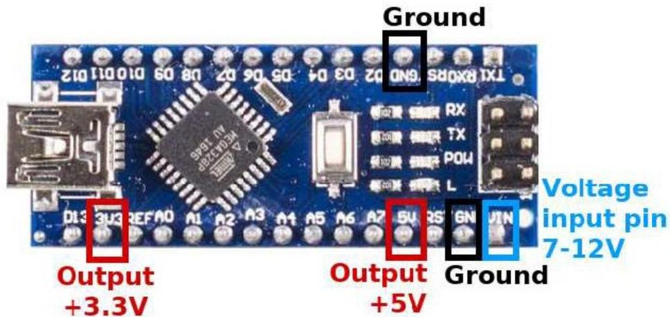
Der Nano V3 hat keine Power-Stiftleiste wie der Mikrocontroller Board mit ATmega328 und ATmega16U2. Er hat +3,3V und +5V Spannungsausgangspins, zwei Masse- (GND) Pins und einen VIN-Pin. Wir haben den VIN-Pin bereits erwähnt, der als DC Eingangspin für eine externe Stromversorgung verwendet werden kann. Ebenfalls haben wir erwähnt, dass das Nano V3 über einen Mini-USB Anschluss mit Strom versorgt werden kann.
