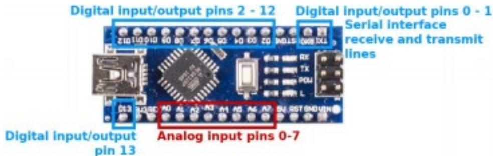
Der Nano V3 ist so aufgebaut, dass digitale Eingangs-/Ausgangspins von analogen Eingangspins getrennt sind. Es gibt 8 analoge Eingangspins (Die Pins A6 und A7 sind nicht beim Mikrocontroller Board mit ATmega328 und ATmega16U2 enthalten) und davon getrennt 14 digitale Eingangs-/Ausgangspins.
