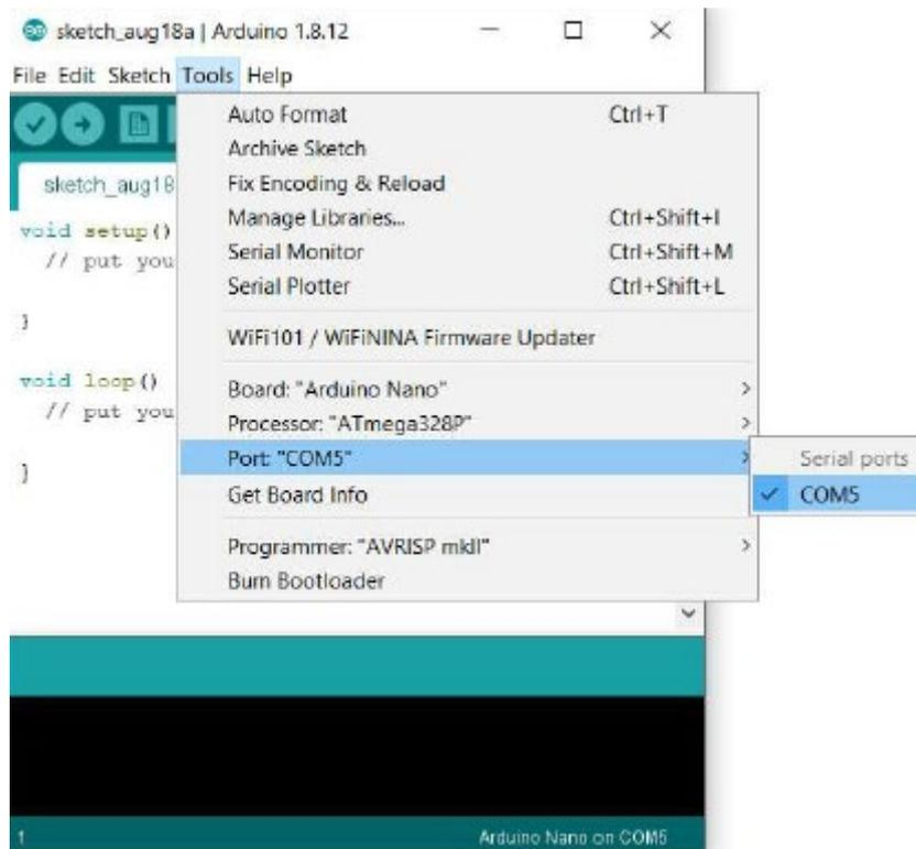
Bei fast allen modernen Betriebssystemen wird diese Schnittstelle automatisch erkannt. Sollte dies bei Ihnen nicht der Fall sein und Sie bekommen keine COM-Schnittstelle angezeigt, müssten Sie zunächst die Treiber-Software für den CH340 (so heißt der Chip auf der Unterseite des Nano V3) für Ihr Betriebssystem installieren. Einfach Im Browser Suchfenster CH340 und Ihr Betriebssystem eingeben. Download, Installation und Neustart dauern maximal fünf Minuten.
